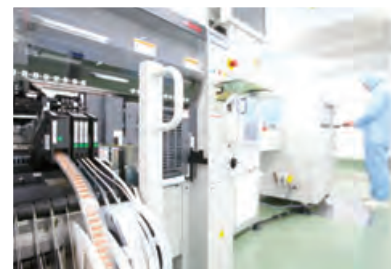
クリーンルーム内に設けられたLEDモジュール実装ライン
