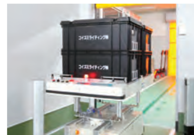
クリーンルーム内を清浄に保つため、完成品は無人搬送車で運搬
