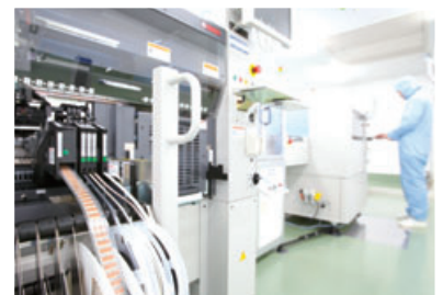
クリーンルーム内に設けられたLEDモジュール実装ライン
