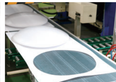
独自の生産技術力で圧空成型機によるセード2個取り生産を実現
