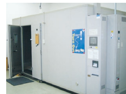
恒温恒湿槽でのホルムアルデヒド簡易測定設備
